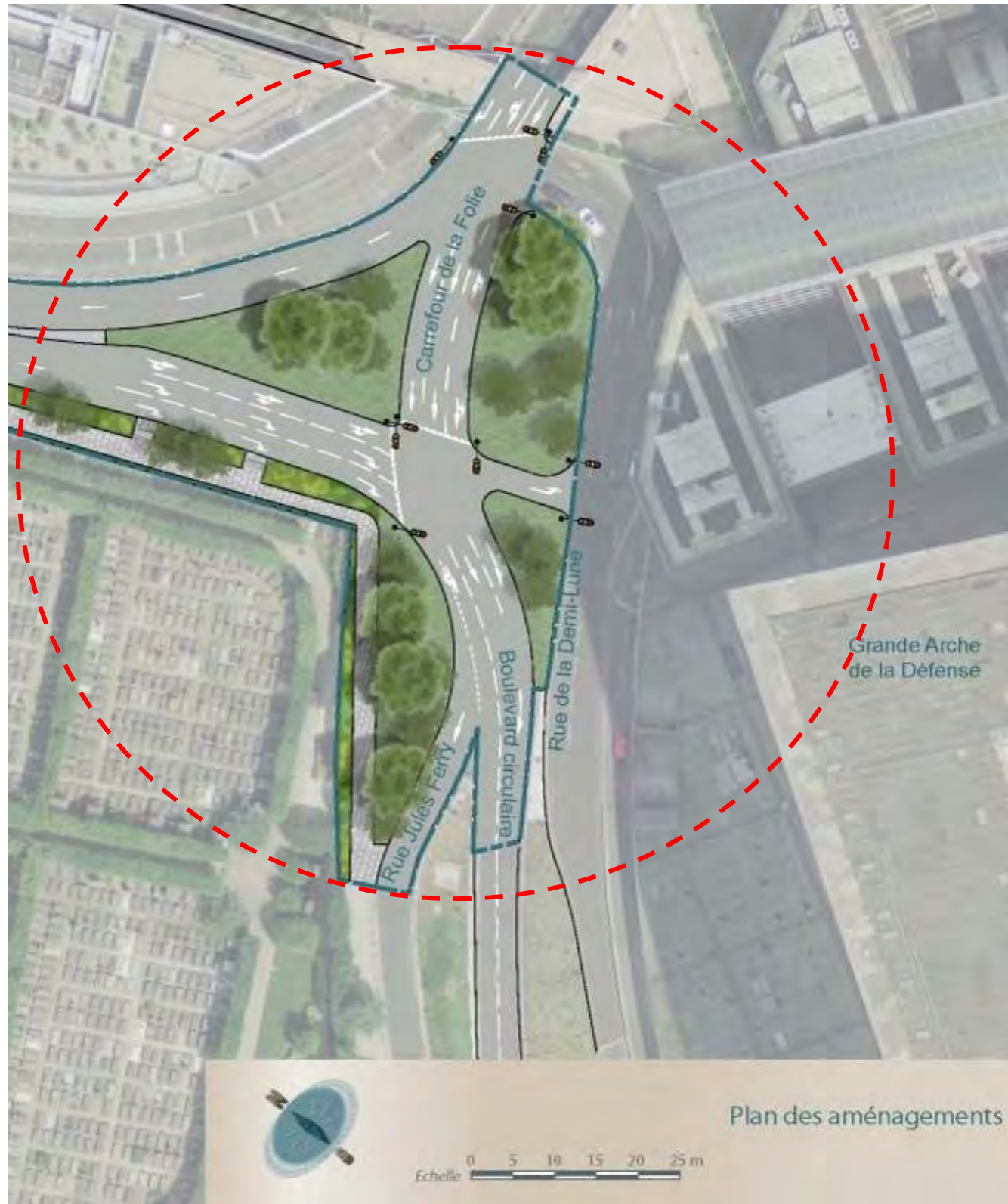
Figure 28 : Géométrie du carrefour de La Folie
