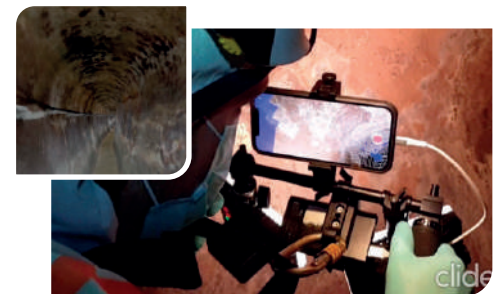
22. MATÉRIEL PERMETTANT L'ACQUISITION DE DONNÉES PHOTOGRAMMÉTRIQUES EN RÉSEAU ET RENDU PHOTOGRAMMÉTRIQUE
