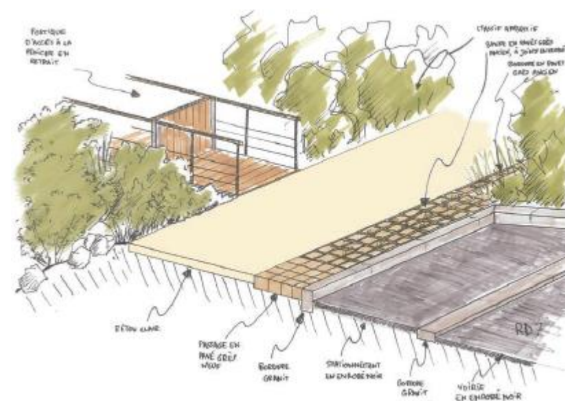
Figure 53 : Principe d'agencement des matériaux sur les zones avec des garde-corps
