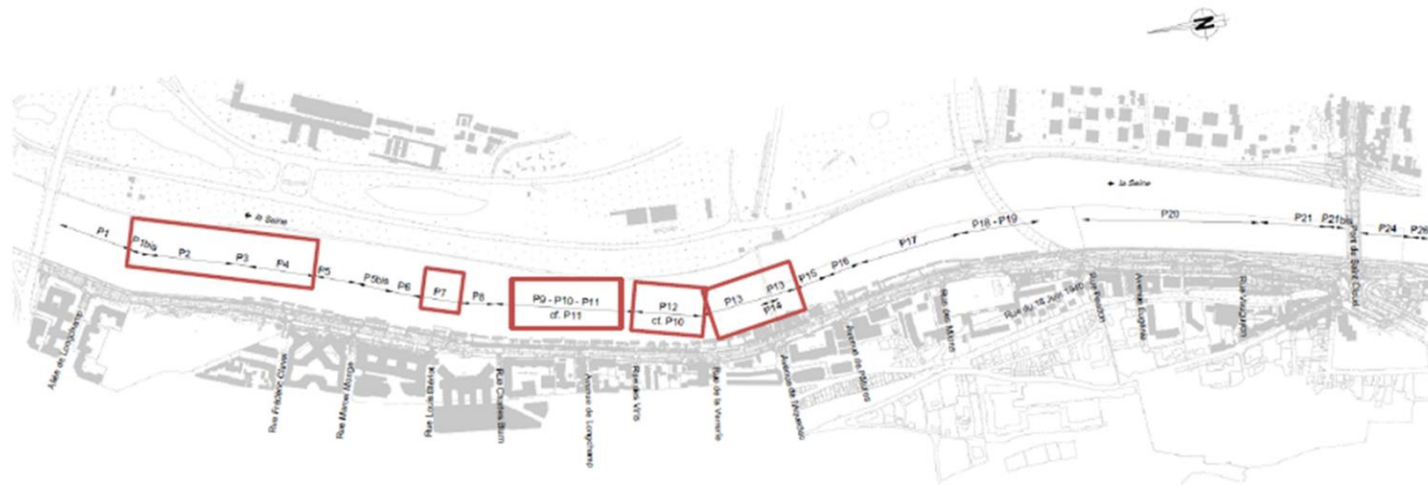
Figure 6 : Section de création de mur de soutènement (hors aménagement Clemenceau)
