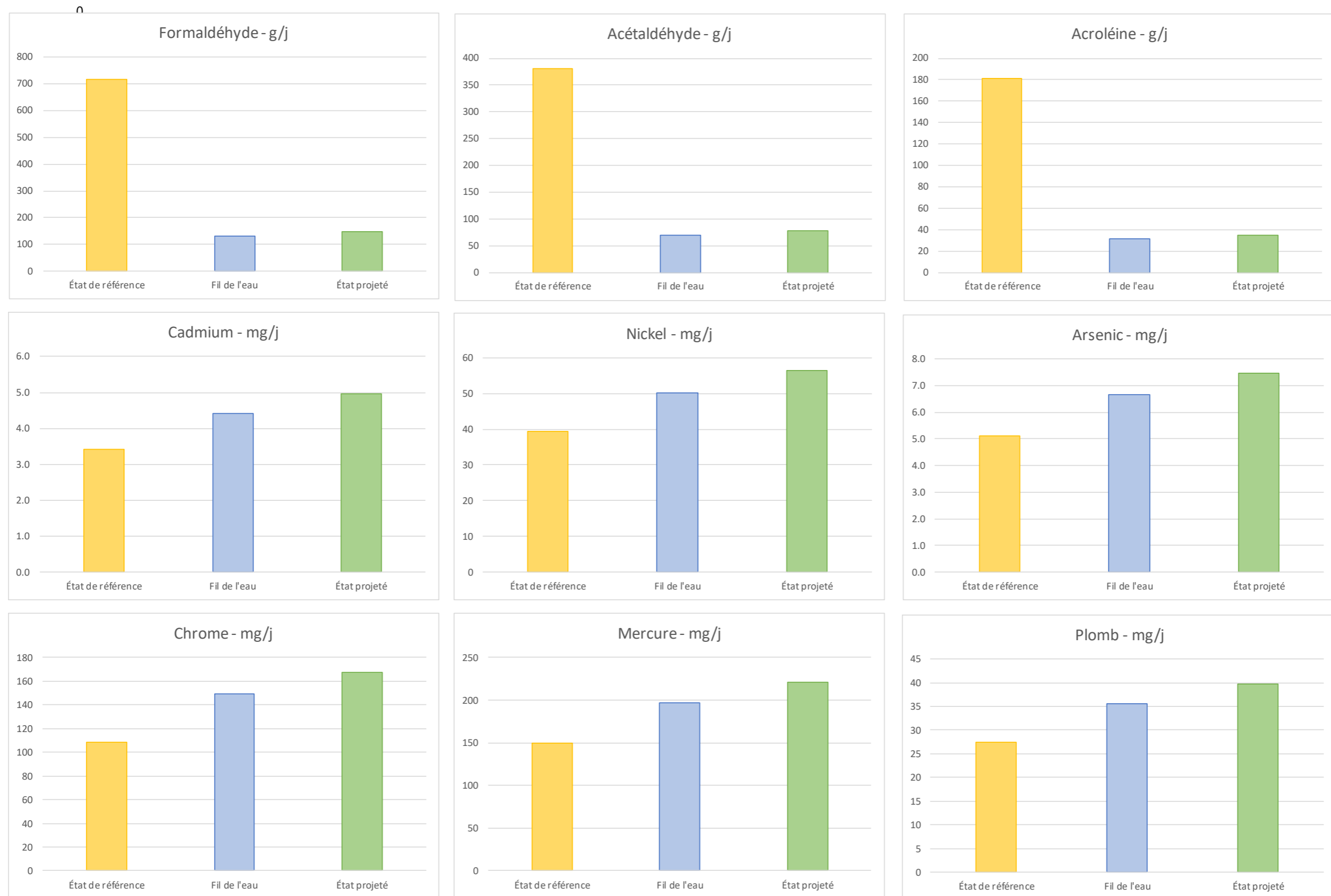
Figure 84 : Évolution des émissions totales par polluant par état sur l'ensemble du réseau retenu
