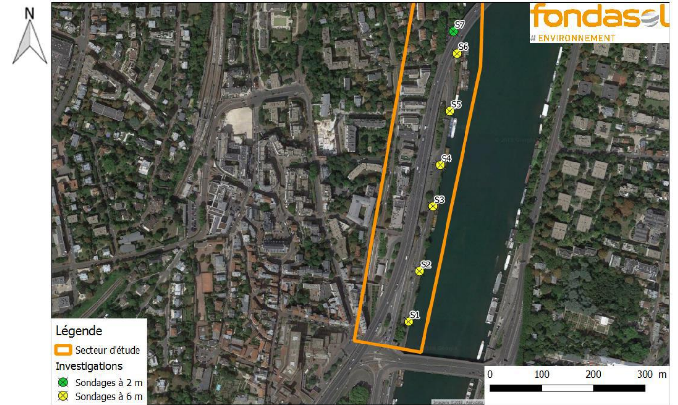
Figure 82 : Localisation des investigations secteur SAINT-CLOUD 3/3
